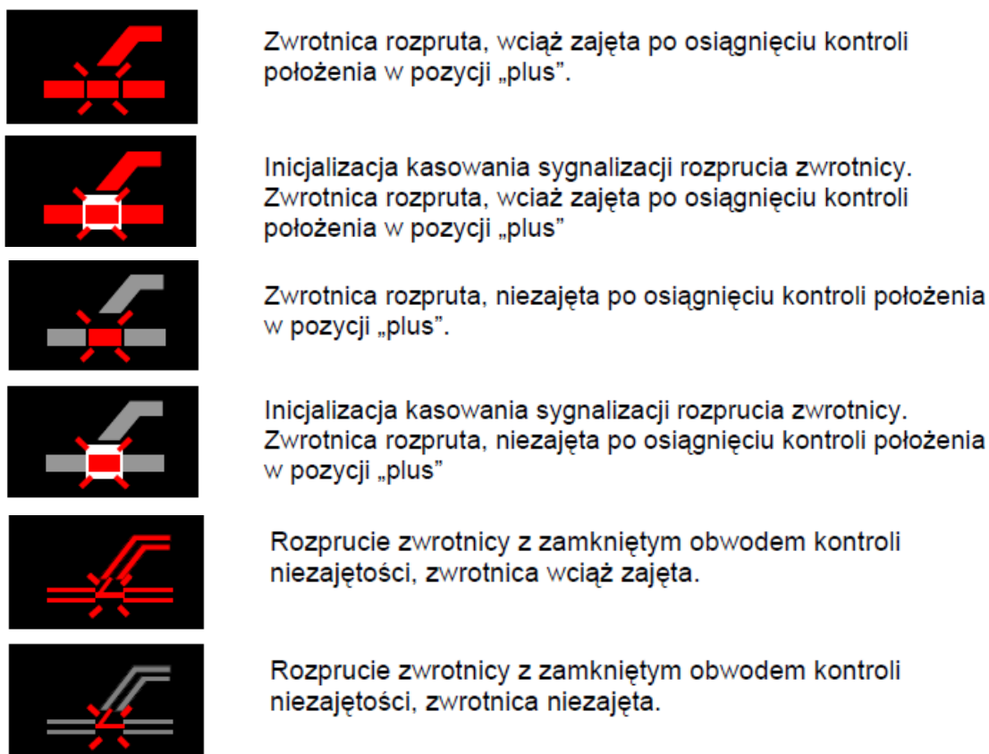
Rys. 44. Przykłady symboli wykorzystywanych do oznaczania rozprucia zwrotnic na komputerowych pulpitych nastawczych EBI Screen 300
